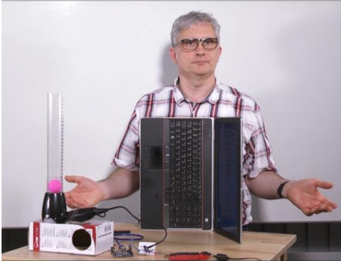
Mitbauvariante mit Originalkarton des Föhns und integrierter WebCam des Notebooks
